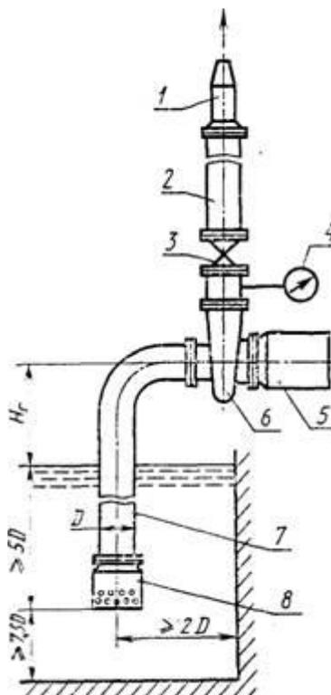
1—ручной пожарный ствол; 2 — пожарный рукав; 3 — запорная задвижка; 4 — прибор для измерения давления; 5 — приводной двигатель мотопомпы; 6 — насос мотопомпы; 7—всасывающая линия; 8— всасывающая сетка
